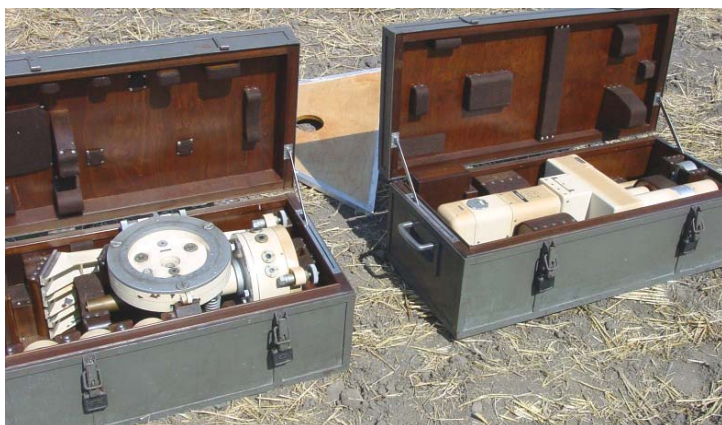
7. ábra. Az E54 inga szállításra bedobozolt-, illetve mérésre kész állapotban.
