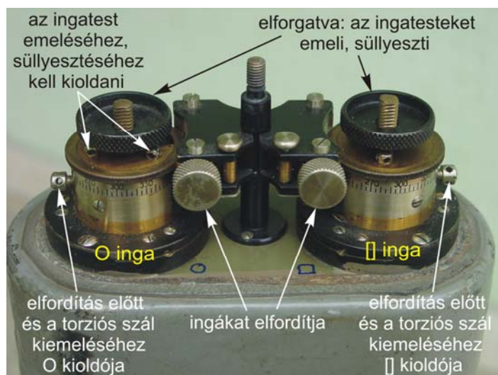
6. ábra. A torziós szálak besabályozó csavarjai
