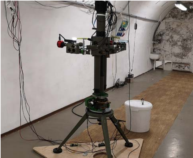
7. ábra. Az Eötvös-kísérlet újramérése 30 m mélységben a KFKI Jánosy Földalatti Fizikai Laboratóriumában az átalakított Eötvös–Pekár-ingával.
