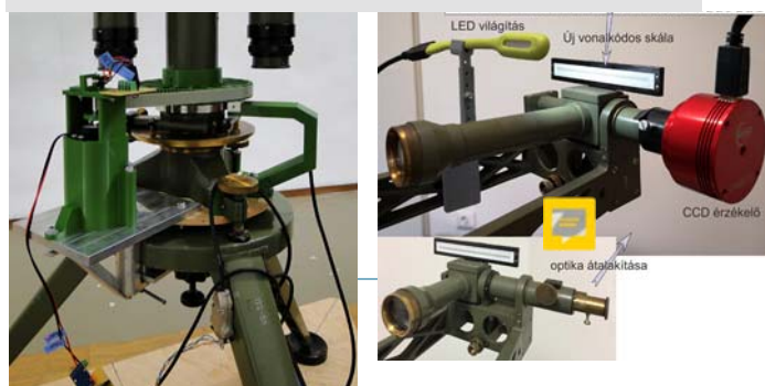
6. ábra. Távvezérelt forgatási mechanika és az automatizált műszerleolvasás kialakítása az Eötvös–Pekár-ingán.
