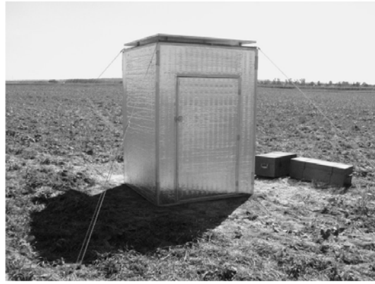
9. ábra. A javított hőszigeteléssel ellátott észlelőház
