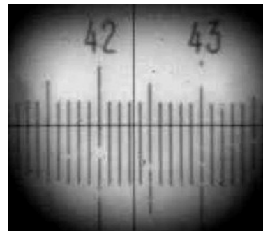
2. ábra. Leolvasás a CCD kamerával
